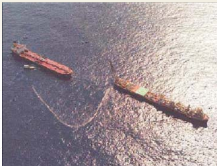
Figura 10 - Exemplo de operação de transferência de petróleo de um FPSO para o navio aliviador.
